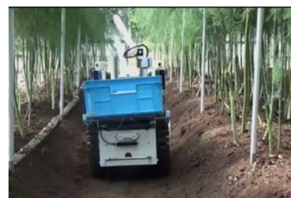
アスパラガスの自動収穫ロボット
