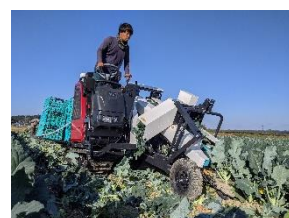
スマート農業機械の導入 (ブロッコリーの自動収穫機)
